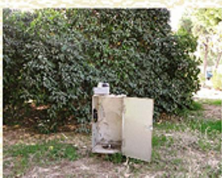
Παρακολούθηση στάθμης και θερμοκρασίας υπόγειων νερών
